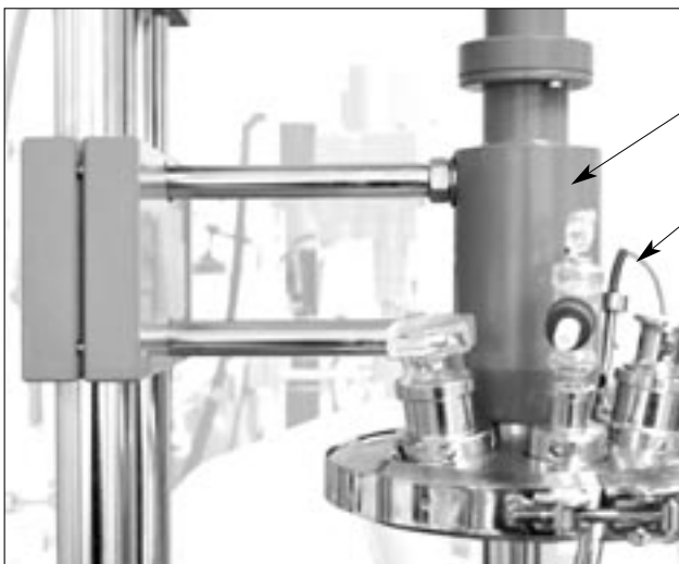
Rührwerksträger mit Rührwellenlagerung
