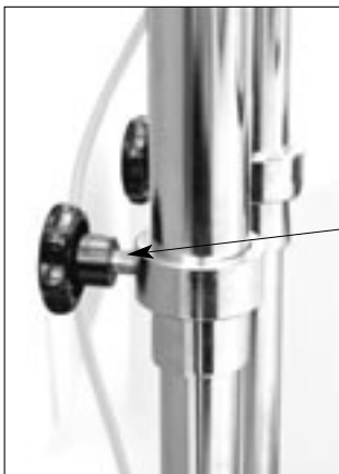
Höhenverstellung nach Lösen der Griffschraube
